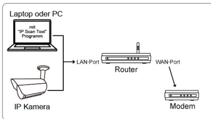
→ Über RJ45 Netzkabel angeschlossene Geräte
