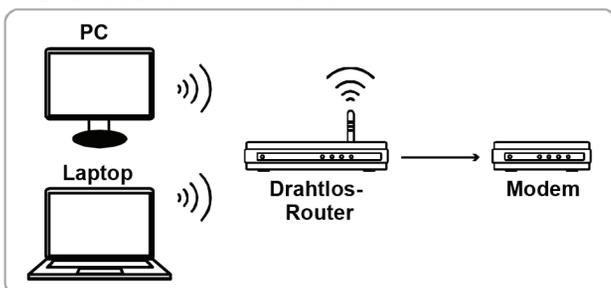
→ Über Netzwerkkabel angeschlossene Geräte    ))) Drahtlos angeschlossene Geräte
